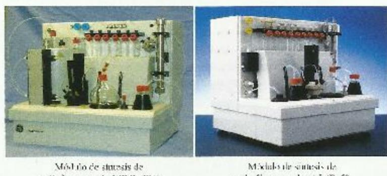
En la figura 3 se puede observar los módulos Fx/FN para llevar a cabo reacciones de sustitución nucleofílica a partir de la cual es posible preparar otros radiofármacos de <sup>18</sup>F, como los que se describen en la Tabla 2, y FxC para la síntesis de radiefármacos de <sup>11</sup>C tales como <sup>11</sup>C-acetato, <sup>11</sup>C-metionina o <sup>11</sup>C-deuterodepreril (ver Tabla 3).
